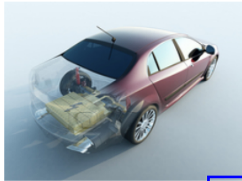
Elektroauto mit Batterie im hinteren Teil des Wagens Quelle: Firstsignal/Getty Images
